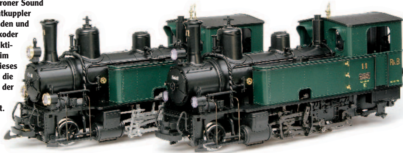
Am linken Lokmodell ist die eingebaute Entkuppplerplatte zu erkennen – das Modell rechts wurde der goldenen Lampenringe beraubt und trägt eine schwarz gefärbte Steuerung.
