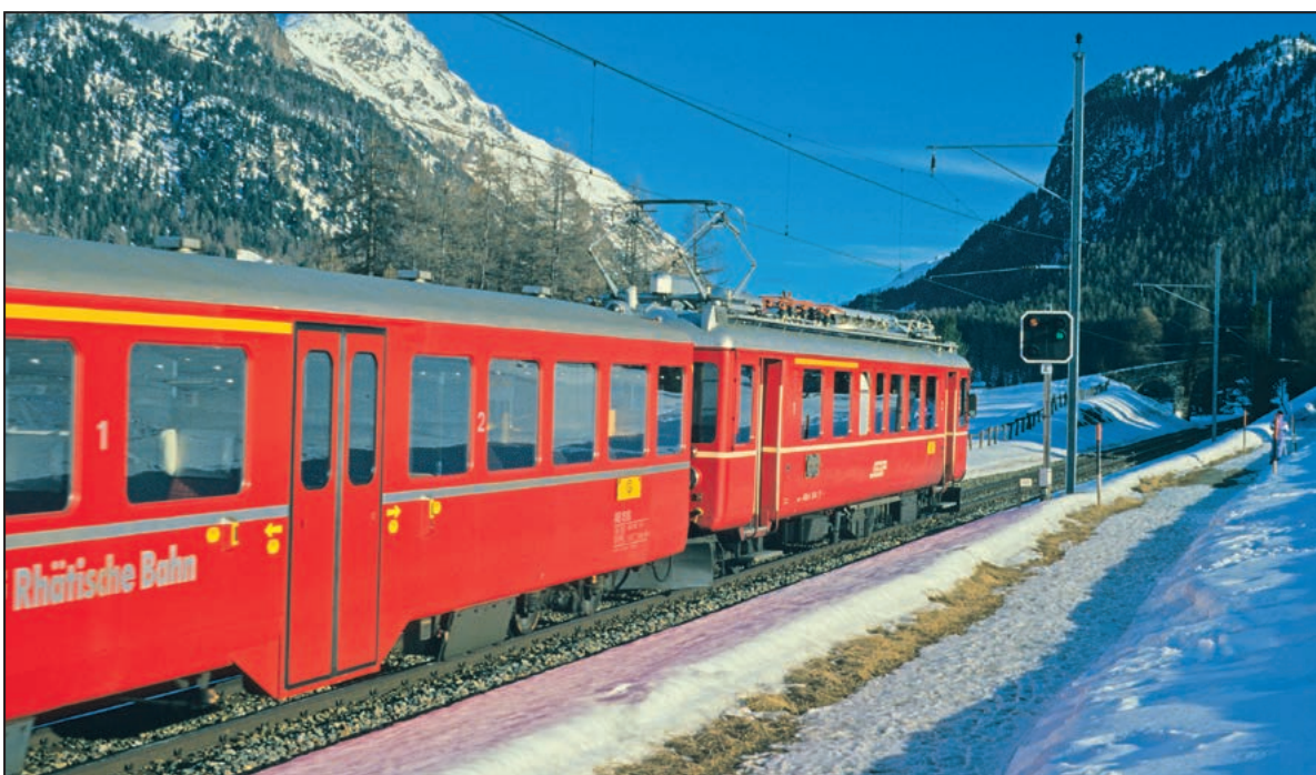
Das Vorsignal kündigt den Fahrbegriff 2 an: Ab dem folgenden Hauptsignal (Einfahrt Pontresina) gilt Fahrt mit maximal 30 km/h
