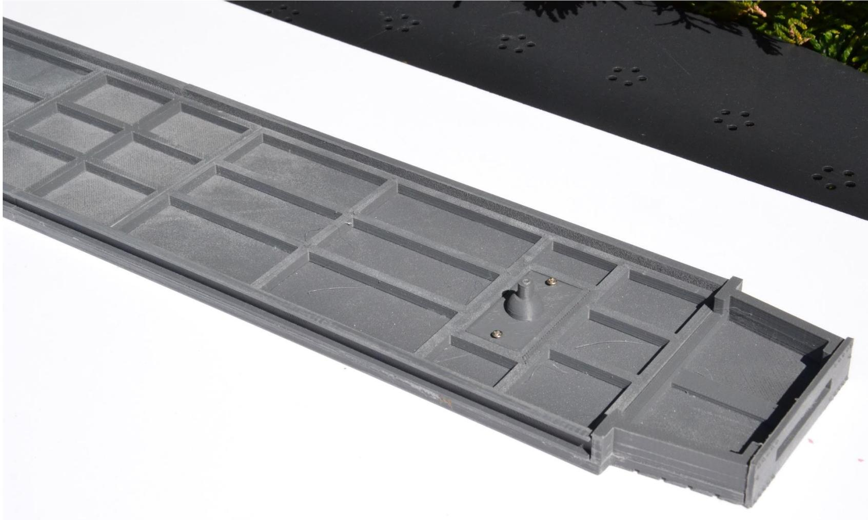
Zusammengebaute Bodenbaugruppe, hier für die Personenwagen, ohne Trittstufen. Drehgestellhalter sind verschraubt, können somit bei Verschleiß gewechselt werden.
