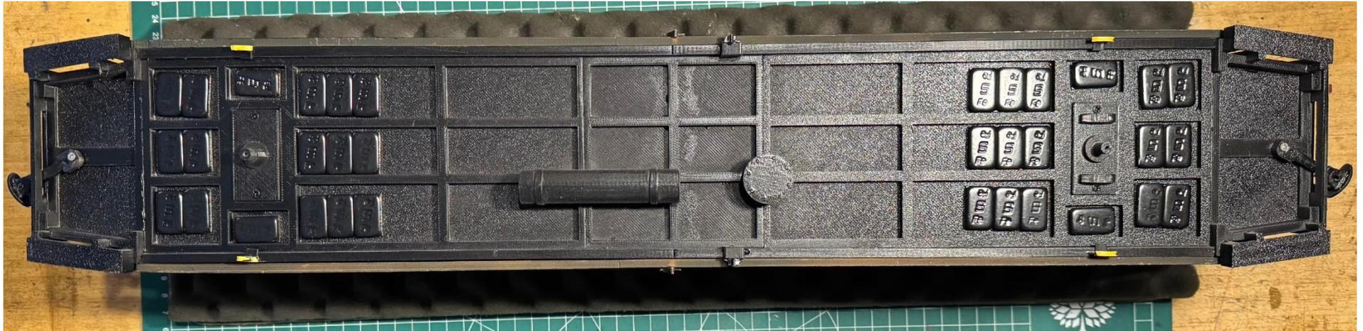
Ansicht der fertigen Bodenbaugruppe (Personenwagen) mit Position der Zylinder und eingeklebten Gewichten.
