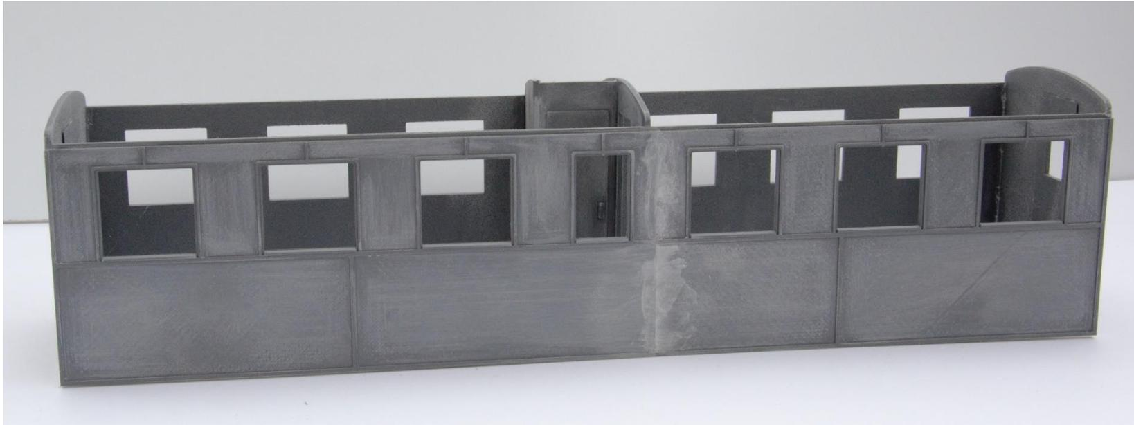
Zusammengebauter Wagenkasten (Bsp. K31). Der Wagenkasten wurde bei mir, nach der Lackierung mit der Bodenbaugruppe verklebt. Der Wagenkasten verdeckt, wie beim Original die U-Profile der Bodenbaugruppe.
