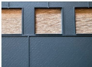
Die flachen Oberflächen lassen nachvollziehen, welche Bahnen der Druckkopf zurückgelegt hat. Diese Bereiche müssen noch geschliffen und gespachtelt werden, bevor Farbe aufgetragen wird.
